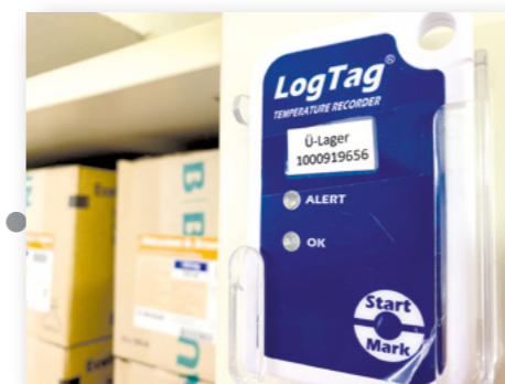
Um die vorgeschriebenen Lagerbedingungen einzuhalten, sind alle Lagerräume klimatisiert. Die Temperatur wird stets durch einen Datenlogger kontrolliert und dokumentiert.
